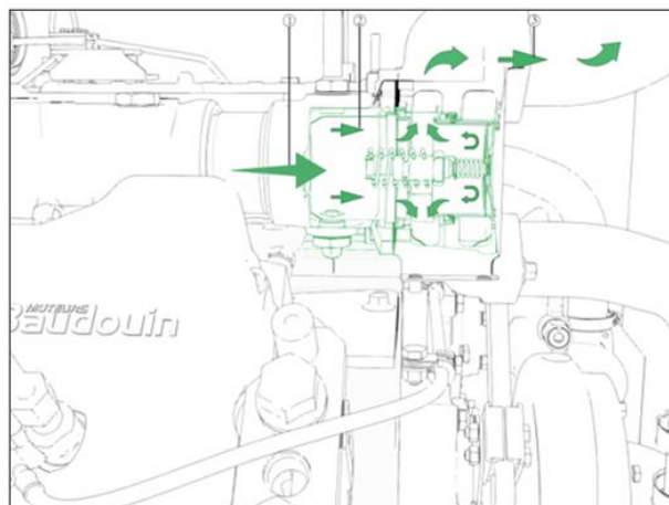
Рисунок 2.4.1Д – Поток ОЖ через блок термостатов. Клапан в открытом состоянии. Двигатель 6М33
