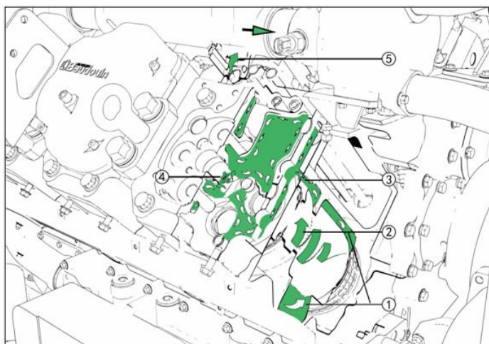
Рисунок 2.4.2Б – Схема циркуляции ОЖ вдоль гильзы цилиндра. Двигатель 12М33
