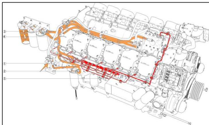
Рисунок 2.6.4Б – Схема движения топлива. Двигатель 12М33СR
